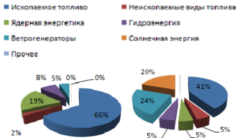
Рисунок 1.6 - Кумулятивная установленная мощность различных источников производства электроэнергии ТЭК Германии ( слева 2000 год, справа 2016 год)
