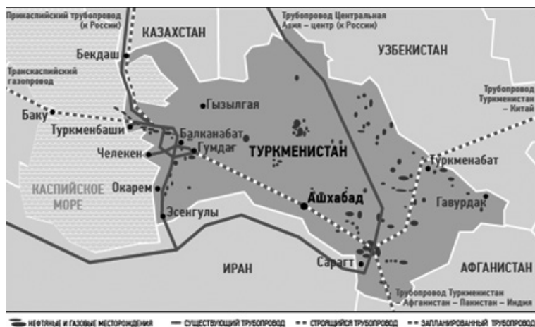
Рис. 3.4. Схема действующих и проектируемых трубопроводов Туркмении
